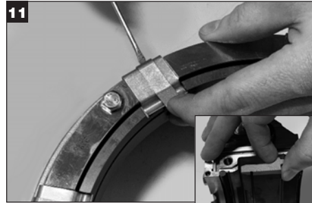
11 スプリングリテーナー (6xから8x) をグランドの両分割片から外します。注:最後のリテーナーを外すと固定環リングを外すことができます。
