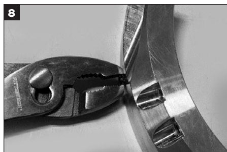
8 回転ホルダーの外径からセンタリングボタン(6x)を外します。
