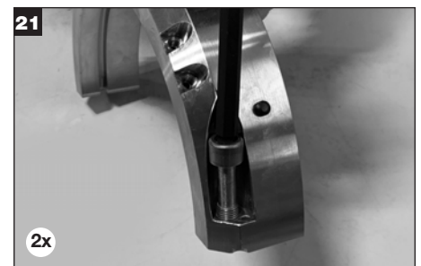
21 推奨される焼付き防止剤でスレッドを潤滑しホルダーキャップスクリューを回転ホルダーの分割片に取付けます。
